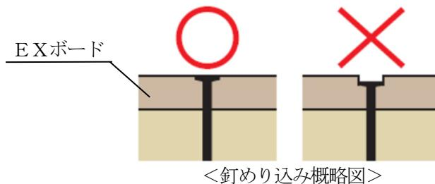
※自動釘打ち機で打ち込み不足が生じた場合、ハンマーなどで釘頭がEXボード表面と面一になるように留め付けてください。
