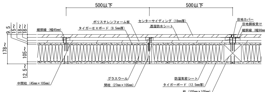
【センターサイディング縦張り（横胴縁）仕様】（中空部に充てん断熱材を挿入した場合の壁構造）
